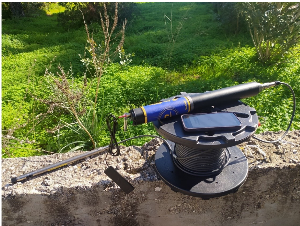
Φωτό 1: Σύστημα καταγραφής υδρογεωλογικών παραμέτρων που περιλαμβάνει: α) αισθητήριο όργανο Aqua TROLL 200, β) σύστημα τηλεμετρίας VuLink CI και γ) καλώδιο Rugged Twist-Locke.
